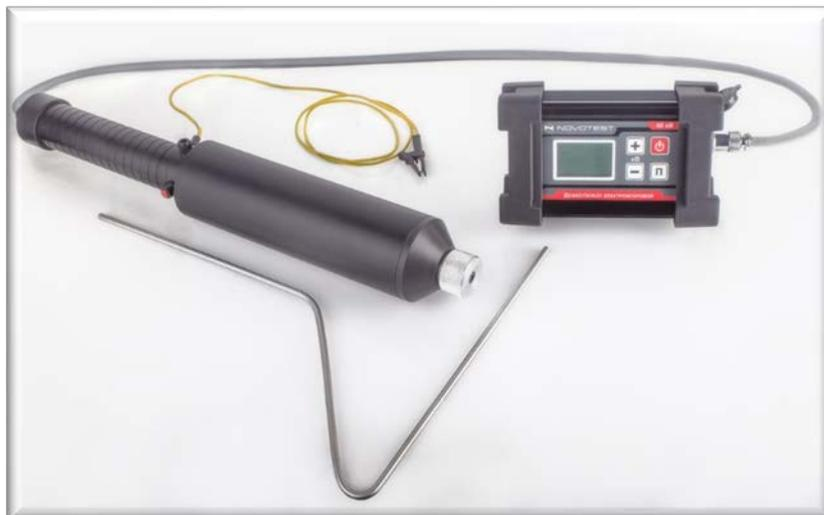
Принцип работы прибора основан на электроискровом методе. Датчик-электрод, подключенный к одному полюсу источника напряжения, сканирует поверхность объекта непосредственно по покрытию. Второй полюс источника напряжения от разъёма заземления соединяется с металлической конструкцией напрямую. Электронный блок фиксирует пробой воздушных промежутков напряжением между электродом и токопроводящим основанием.
