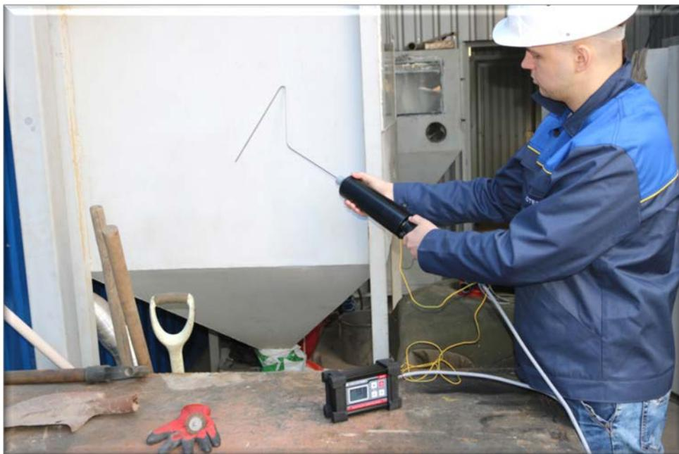
В зависимости от задачи прибор может быть оснащен Т-образным, серповидным, щеточным, кольцевым, пружинным и прочими типами электродов под индивидуальные объекты контроля заказчика.
