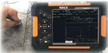
Динамическое отслеживание луча и визуализация расположения дефекта
