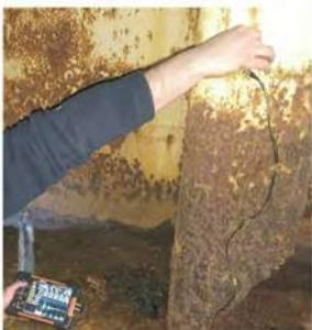
Измерение толщины портового дока
