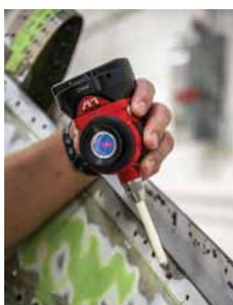
vProbe с интеллектуальными кнопками и стилусом RFID, выполняющий точечное измерение
