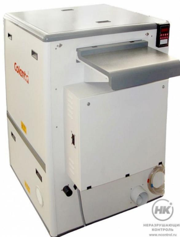
Проявочная машина Colenta INDX 43/55 предназначена для автоматической обработки промышленных рентгеновских плёнок в больших объёмах. Высокопроизводительная машина подходит для рулонных и форматных плёнок шириной до 43 см, при этом скорость протяжки составит 54 см/мин с полным циклом проявки длительностью 8 мин.
